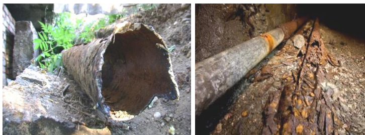
Рисунок 1 – Почвенная коррозия металлов
