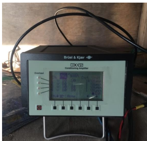
Рисунок 4 – Четырехканальный кондиционирующий усилитель Delta Tron 2693A-OS4
