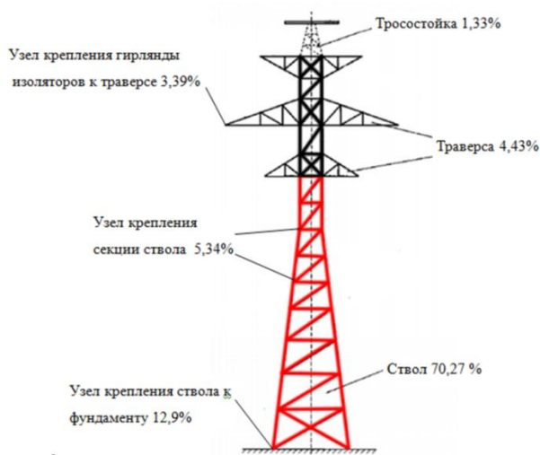
Рисунок 1 – Распределение повреждений элементов металлической опоры
