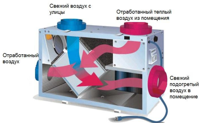
Рисунок 1 – Принцип работы рекуператора
