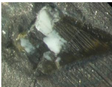
Рисунок 4 – Площадка износа кристалла алмаза с трещинами
