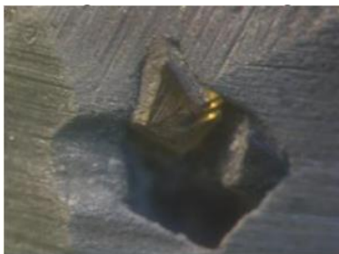
Рисунок 5 – Последние части кристалла и образовавшаяся лунка в металлической связке
