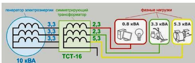
Рисунок 2 – Подключение более мощной нагрузки с использованием ТСТ
