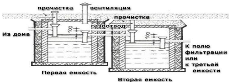
Рисунок 1 – Устройство септика на дачном участке (схема)
