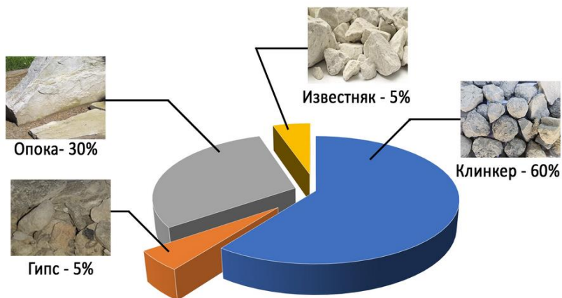
Рисунок 1 – Состав цемента с добавкой опоки и известняка
