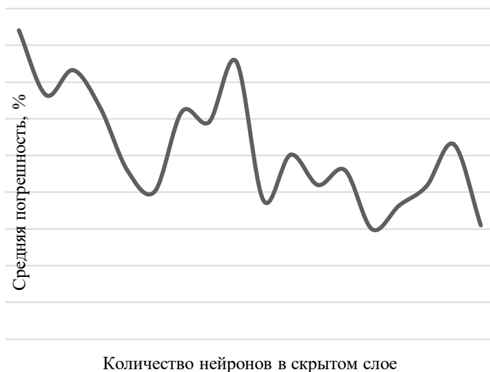
Рисунок 3 – Зависимость средней погрешности по каждому выходу от количества нейронов в скрытом слое
