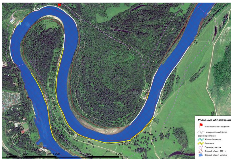
Рисунок 1 – Размываемые и укрепленные зоны, места наибольших смещений русла на участке Северного водозабора реки Уфа
