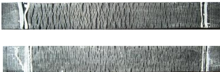
Рисунок 3 – Наличие трещин на образцах, подвергнутых озонному старению, содержащих стабилизаторы 6PPD(а) и АДФА-2ОП(б)
