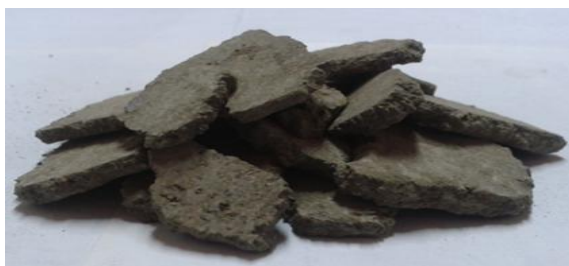
Рисунок 1 – Измельчаемый материал клинкер после обработки в ПВИ
