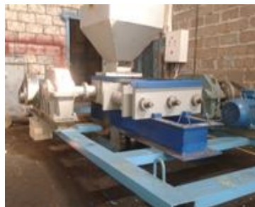
Рисунок 3 – Пресс-валковый измельчитель с дезагломерирующим устройством
