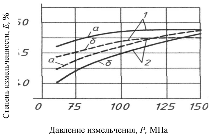
Рисунок 4 – График зависимости степени измельченности от давления измельчения:
