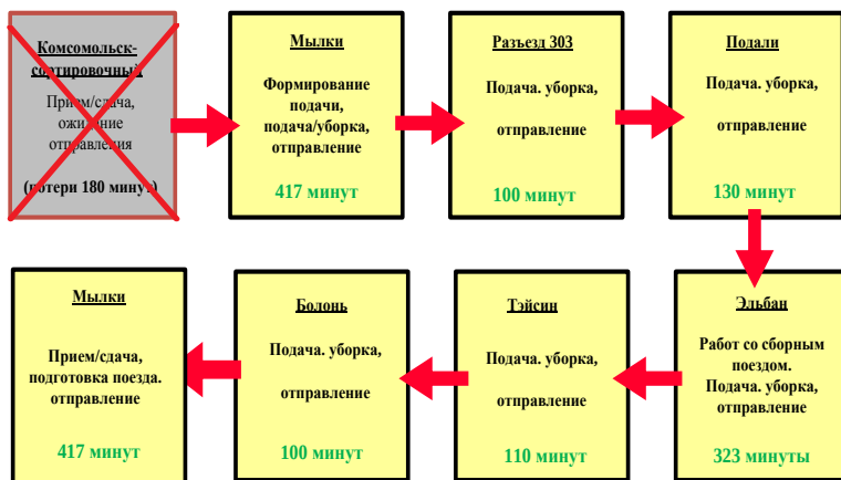
Рисунок 4 – Работа маневрового локомотива при базировании на железнодорожной станции Мылки
