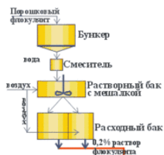
Схема приготовления раствора порошкового флокулянта
