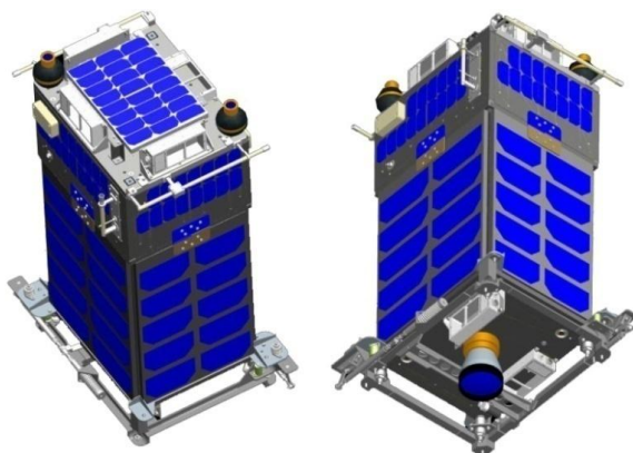
Рисунок 1 – Общий вид МКА «ГЕЛИОС» со сложенным солнечным парусом
