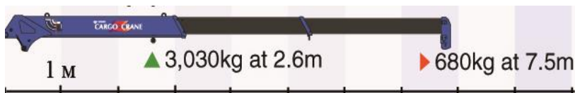
Рисунок 1 – Характеристика стрелы TADANO ZR 303(H)
