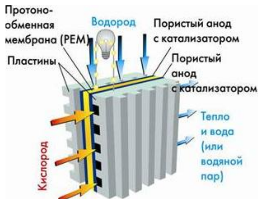
Рисунок 1 – Схема топливного элемента
