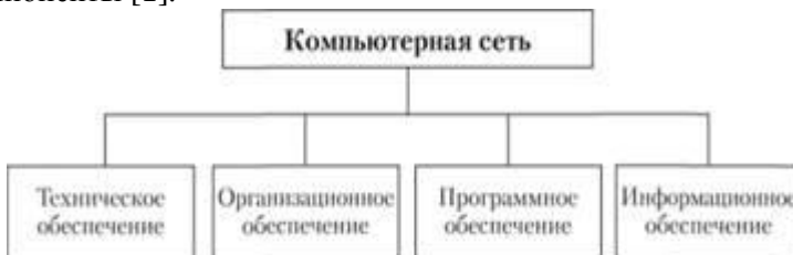
Рисунок 1 – Состав базовых компонентов компьютерной сети
