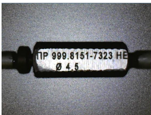
Рисунок 2 – исходное и результирующее изображения с лазерной гравировкой
