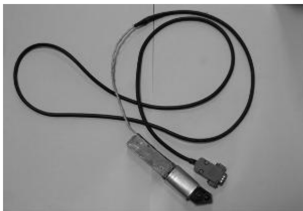
Рисунок 2 – Резец с тензодатчиками и припаянным к нему кабелем для соединения с измерительным комплексом
