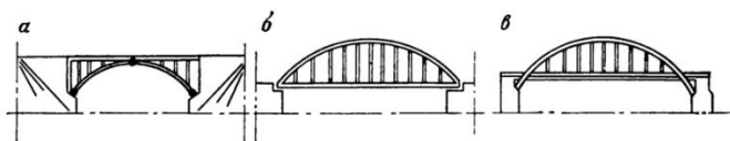
Рисунок 2 – Схема балочных мостов: а) трёх шарнирная арка с ездой поверху; б) арка с затяжкой с ездой понизу; в) арка с ездой посередине.
